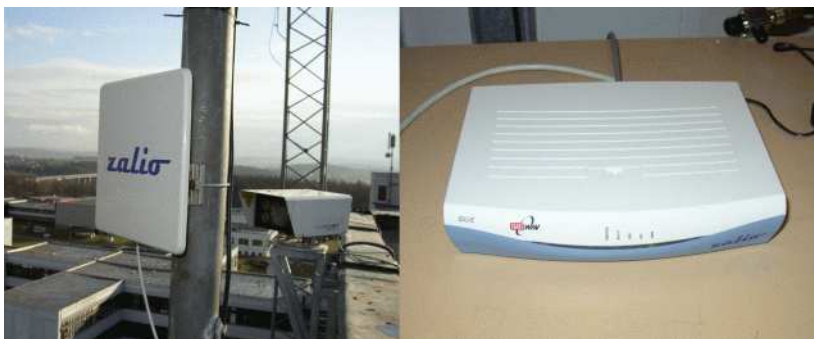
Obrázek 2: WinLink 1000 - ODU s integrovanou flat anténou a IDU-E
